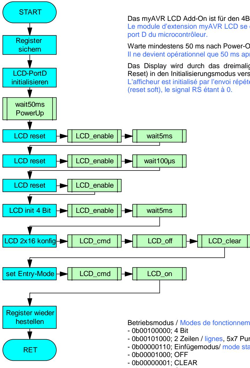
Das myAVR LCD Add-On ist für den 4Bit Modus über Port D konfiguriert.
