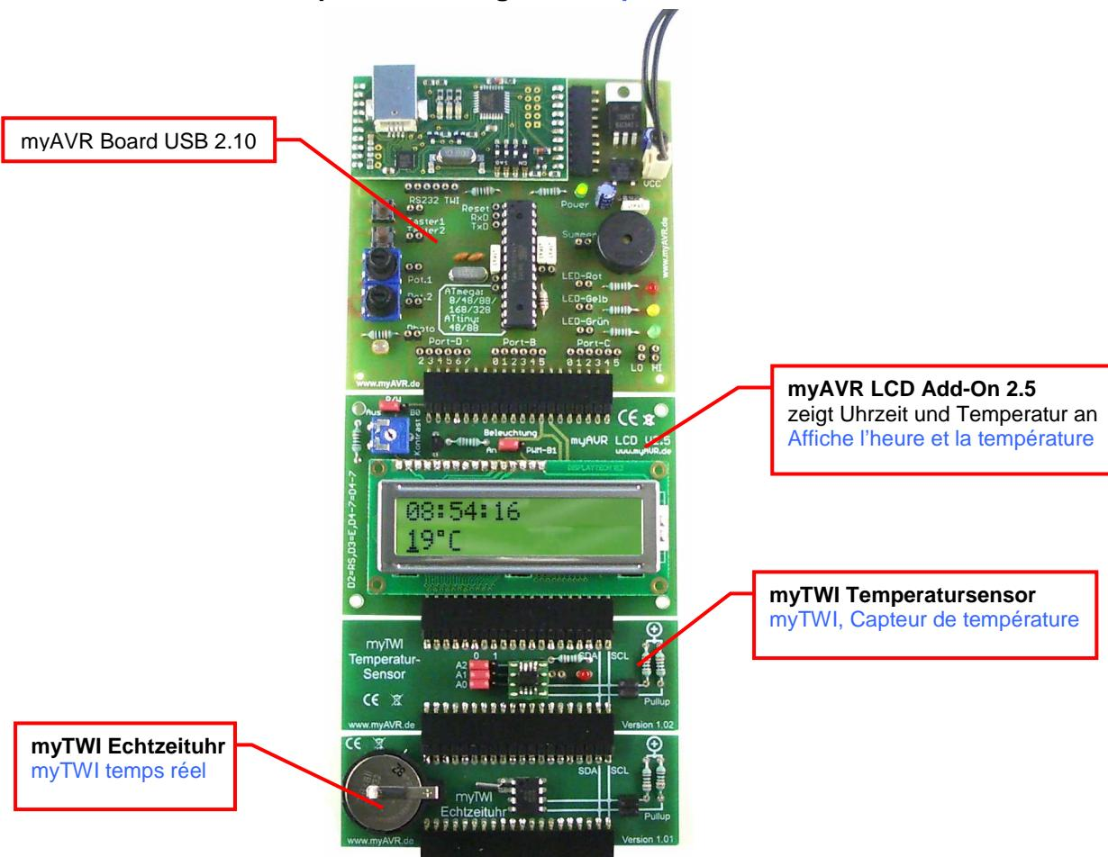
Die Abbildung zeigt das myAVR LCD Add-On an ein myAVR Board USB angeschlossen und erweitert mit:
