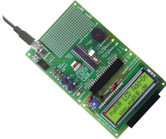
Abbildung / picture: myAVR Board light mit myAVR LCD Add-On myAVR board light with myAVR LCD Add-On
